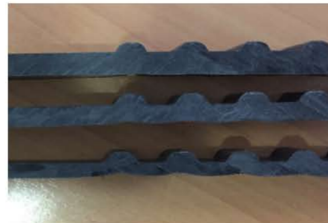
Die unterschiedlichen Wandstärken im Querschnitt.
