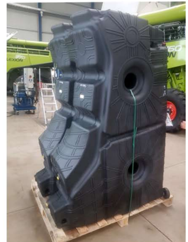
Das neue Tanksystem mit Verstärkungen.
